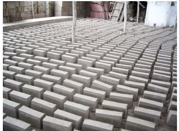
Figure 3. Preparación del muro de adobe y sus piezas de 24x12x6cm.
