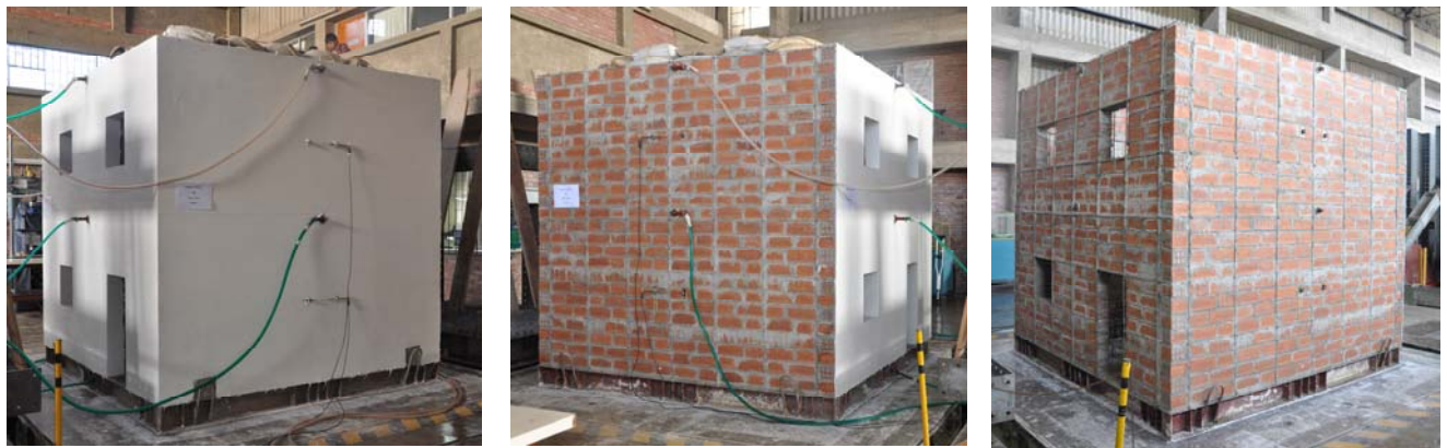
Figure 15. Tres vistas del edificio por sus 4 paredes, 2 con enfoscado y 2 sin enfoscarse, donde a pesar de las 4 etapas del ensayo realizado con armaduras previamente ensayadas con el prototipo de adobe, no ha aparecido ninguna mínima fisura (ni grieta), por ninguna parte.
