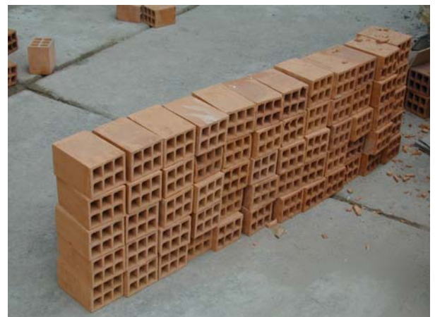
Figura 4. Preparación del muro de ladrillo hueco con perforaciones horizontales de 24x11,5x9,5cm.
