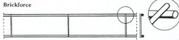
Fig. 2.—Armaduras prefabricadas planas para la fábrica armada.
