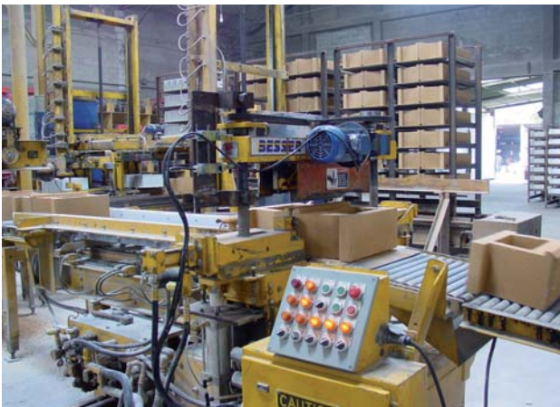
Figura 2.- Vista del proceso industrial de fabricación de las piezas de mampostería de hormigón.
